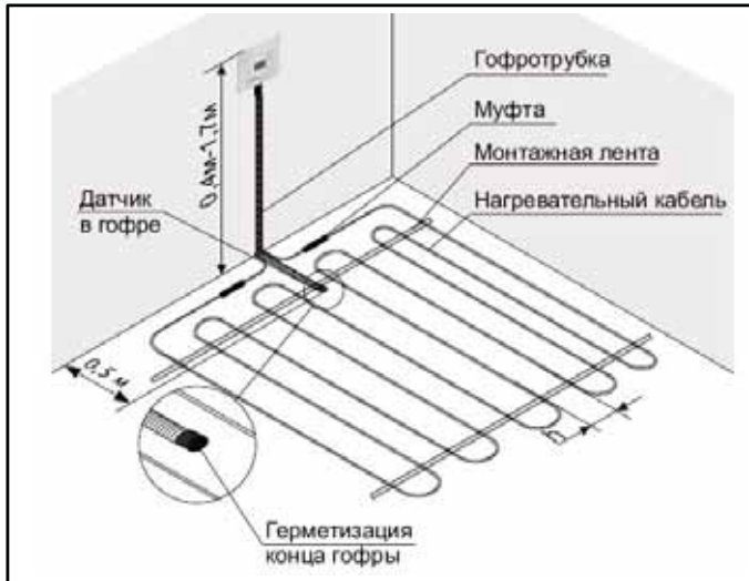
Рис. 1 Схема установки датчика температуры
